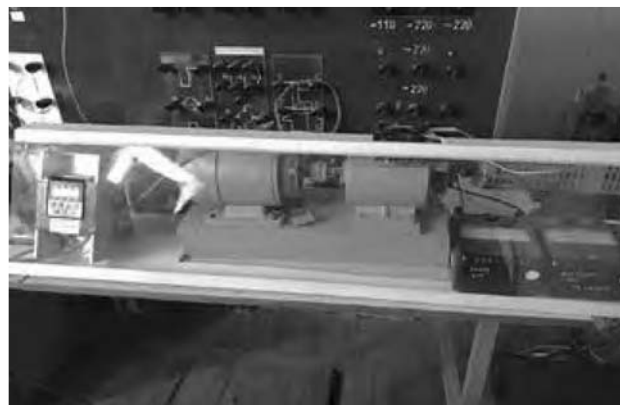
Рис. 9. Готовий стенд для дослідження АД з КЗ-обмотко
